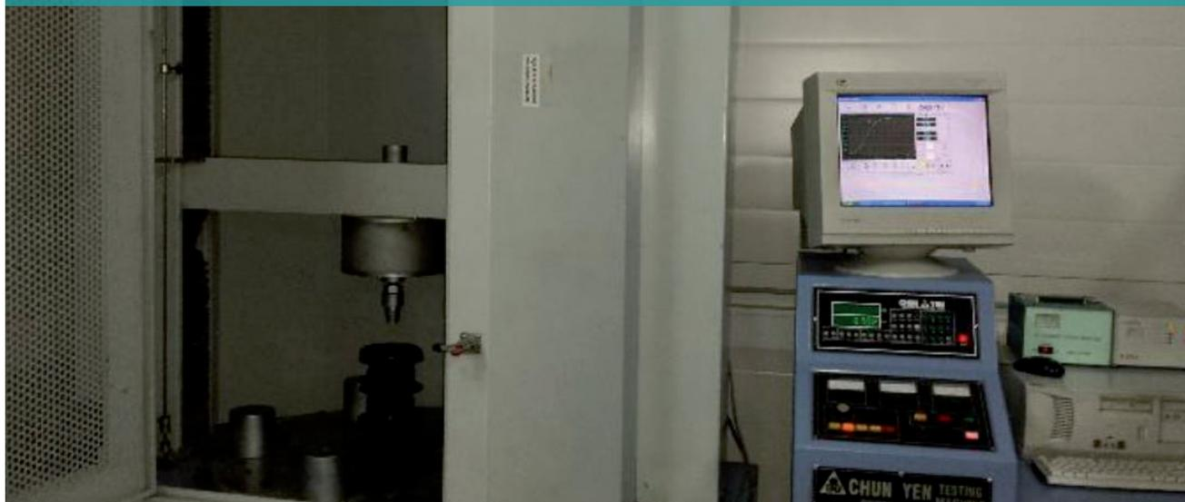
На опоры различной высоты (**от 50 до 380 мм**) подавалась вертикальная нагрузка со скоростью **16 мм/мин**. Значение предела прочности на разрыв, выраженное в килоньютонах и килограммах, является результатом проведения испытаний на прочность регулируемых опор **Level**.
